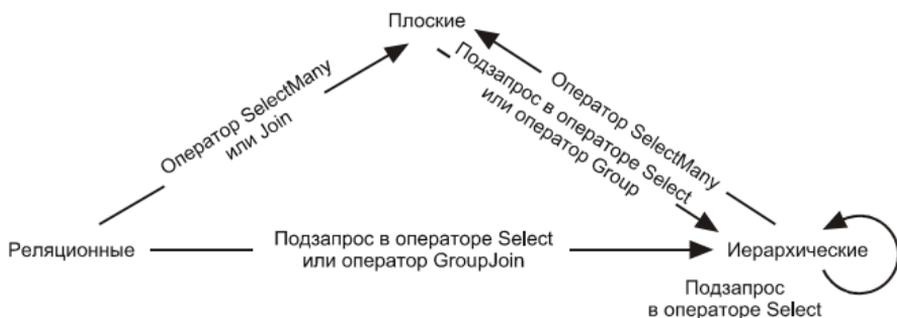
Рис. 10. Проецирование иерархии объектов
